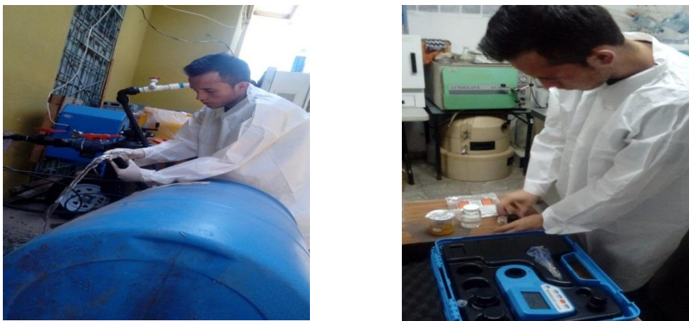
Figura 2. En la izquierda, toma de muestras de agua del sistema purificador y a la derecha, comprobación de la ausencia de cloro que no interfiriera con el ensayo.
