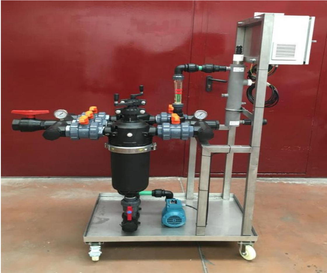
Figura1. Eco Reactor de Fotocatálisis UV/ TiO 2 , en la que se observa los sistema de filtro y el reactor donde se genera los radicales libres.
