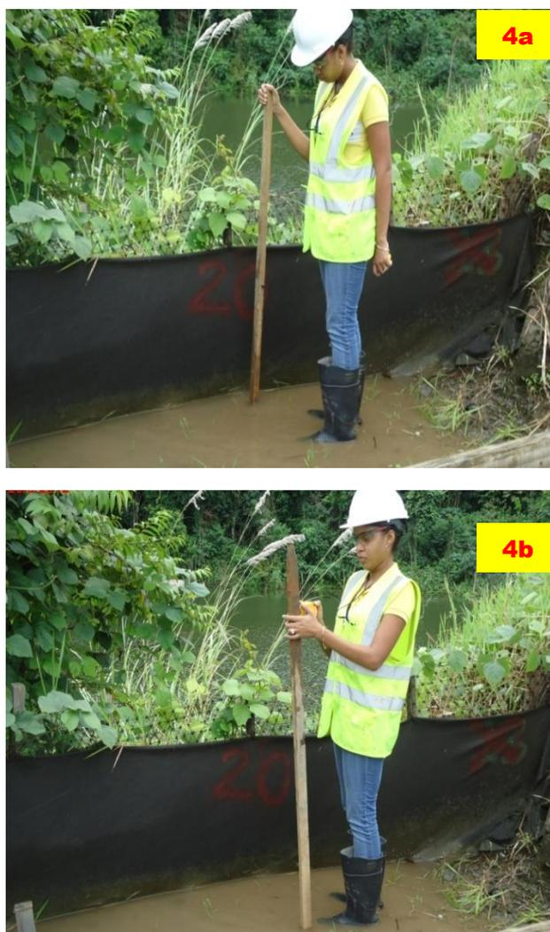
**Figura 4 Medición del volumen en las Trampas de Sedimentos.** Regla de campo en cm. diseñada para realizar las mediciones en los campo (4a). Con la ayuda de una cinta métrica se determinó en centímetro la cantidad de sedimentos(4b).(Fuente: GUPC, 2012-2013)
